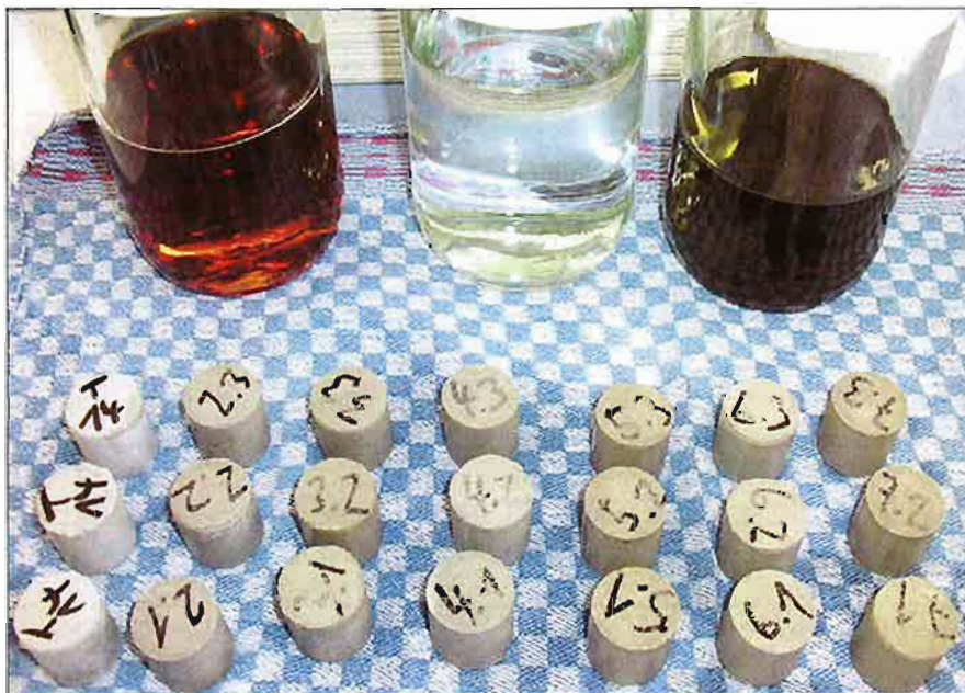
■ Prüfkörper nach Einlagerungsversuchen; Foto: Säurefliesner-Vereinigung, Großburgwedel
