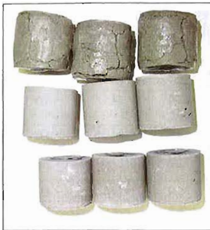
■ Zustand von Prüfkörpern nach siebentägiger Einlagerung in unterschiedlichen Reinigungsmitteln; Foto: Säurefließner-Vereinigung, Großburgwedel
